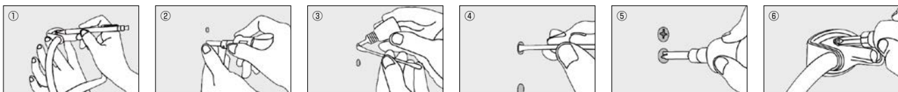
取付ける機材を石こうボードに合わせて、ネジの位置にマーキングします。
